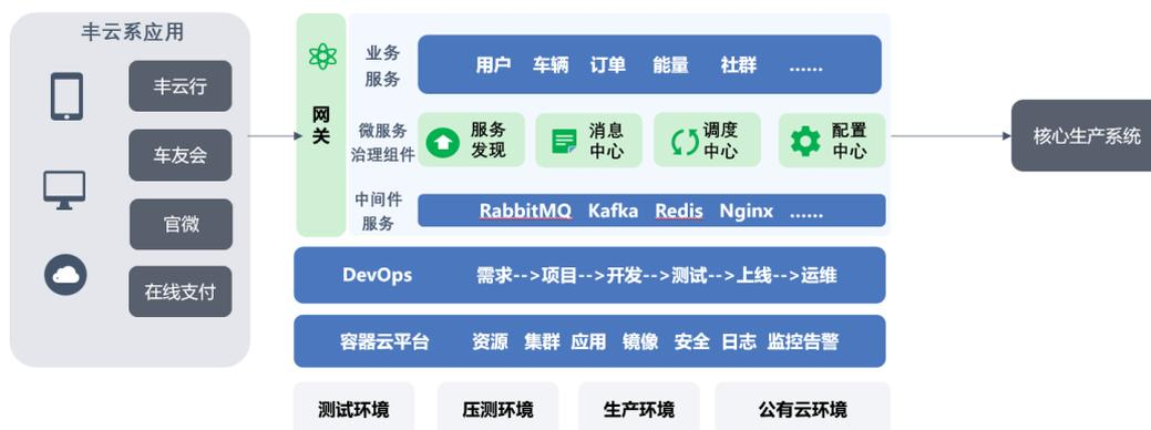
图 10: 广汽丰田云平台架构示意图
